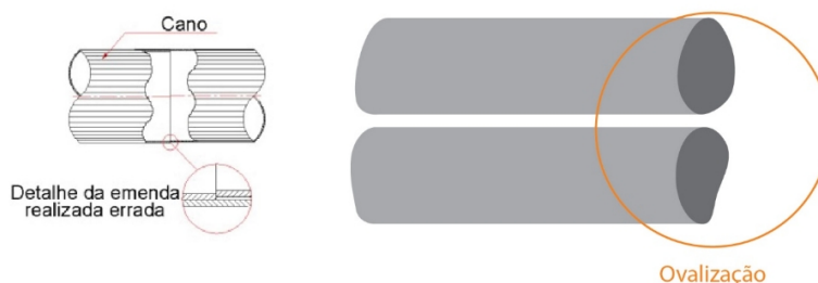
Figura 27- Empalme de tuberías y tuberías "ovalizadas".
