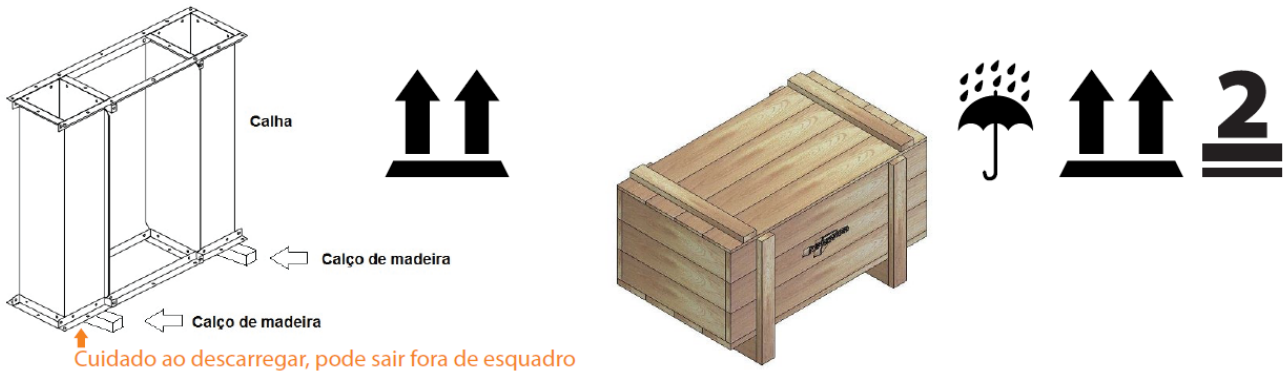
Figura 22 – Almacenamiento de materiales.
