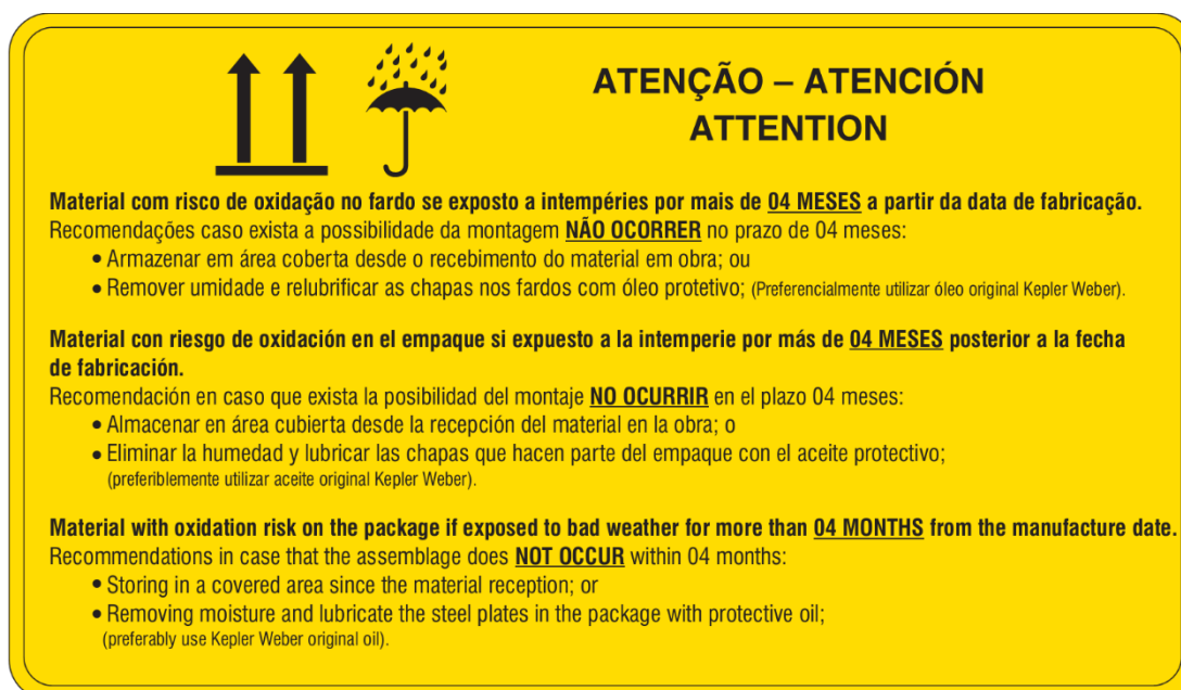
Figura 15 - Etiquetado constante en cada bala de la placa lateral del silo.
