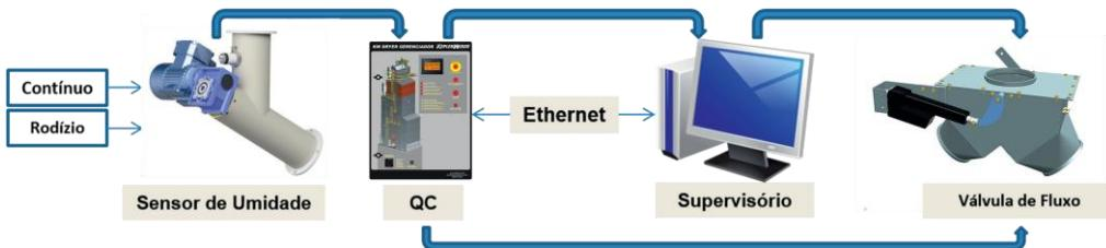
A descarga automática do secador controla a velocidade para estabilizar a umidade dos grãos. Assim, a sua produção fica na condição ideal para ser armazenada.
