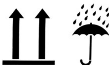
Figura 9 - Identificação do material quanto à posição de armazenagem e proteção contra intempéries.
